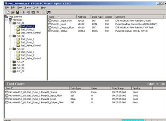
Пакет S7-200 PC Access позволяет выполнять обмен данными между компьютерными приложениями и программируемыми контроллерами S7-200 через стандартный интерфейс OPC.
