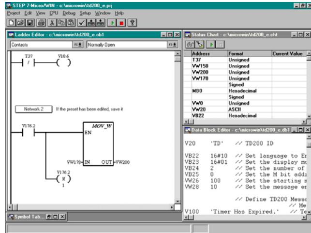
STEP 7 Micro/ WIN позволяет выполнять все операции по программированию контроллеров S7-200, конфигурированию и настройке их параметров, решать задачи конфигурирования и программирования сетевых структур с S7-200, устройств человека-машиинного интерфейса (TD 100C, TD 200, TD 200C и TD 400C), систем регулирования и позиционирования и т.д.
